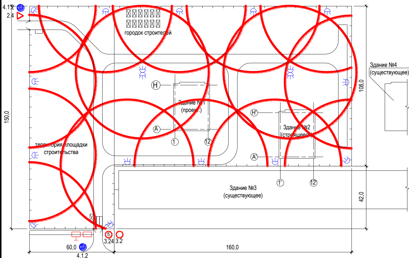
Рис. 28. Размещение осветительных мачт на территории строительной площадки.
